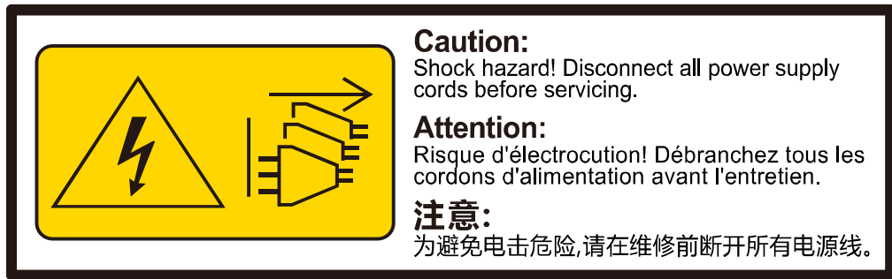
图 8-2 多电源安全防护
